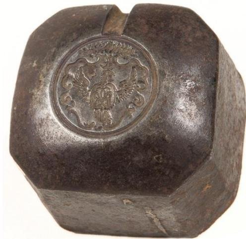
Punzone in ferro a tronco di piramide a base quadrata ad angoli smussati, BM mm 70 bm mm 65, in cui è inserita una matrice d'acciaio circolare, Ø mm 35, per impronta a secco. [sec. XIX].
