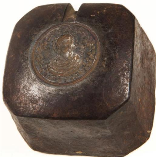
Punzone in ferro a tronco di piramide a base rettangolare ad angoli smussati, BM mm 75 x 70 bm mm 65 x 63, in cui è inserita una matrice d'acciaio circolare, Ø mm 35, per impronta a secco. [sec. XIX].
