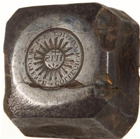
Punzone in ferro a tronco di piramide a base quadrata ad angoli smussati, BM mm 73 bm mm 60, in cui è inserita una matrice circolare, Ø mm 33, per impronta a secco. [sec. XIX].
